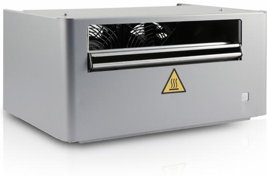
VSDU0A0003 Вентиляторный парораспределитель CAREL выносной, для увлажнителей 1-18 кг/ч. Такой вентиляторный парораспределитель может устанавливаться как прямо сверху увлажнителя, так и крепиться отдельно от него на некотором расстоянии при помощи крепления VSDBAS0001. Вентиляторный парораспределитель подсоединяется к контактам питания увлажнителя в секции электрических соединений (24 В~, контакты X1, X2).
